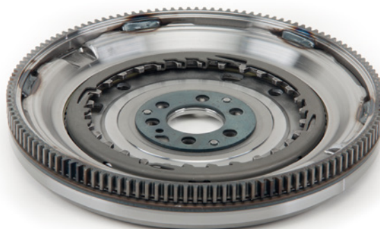
Figura 1: El número de dientes de la corona del motor de arranque de la nueva pieza debe coincidir con la pieza antigua
