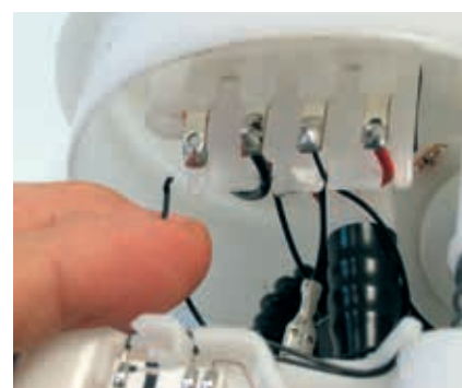
Fig. 3: Manifestación típica de la avería: El cable del sensor del depósito está suelto y las laminillas eléctricas de contacto están dobladas.
