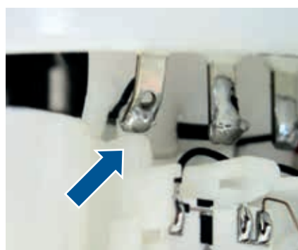
Fig. 2: Debido a la elevada compresión del módulo de alimentación de combustible el cable se corta.
