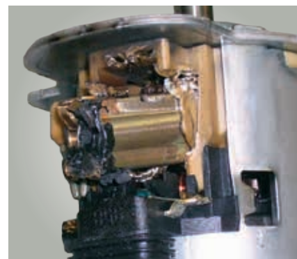
Schadensbild: Schmelzspuren am Elektromotor oder an den elektrischen Kontakten
