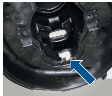
Manifestación de la avería: huellas de fundición en la caja de la bomba (la caja vista desde arriba)
