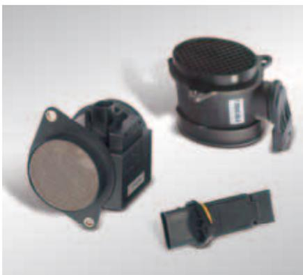
*En el caso de los motores diesel, el sensor de masas aéreas es necesario y sirve entre otras cosas para regular el reciclaje de los gases de escape.*
