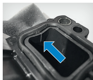
Fig. 2 : Cassure (vue du dommage)
