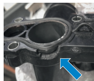
Fig. 3 : Cassure (vue du dommage)
