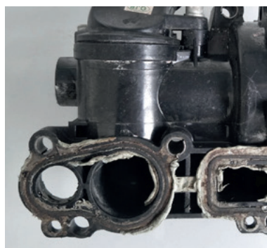
Fig. 5: Fugas debido a un agente obturador adicional (manifestación de la avería)
