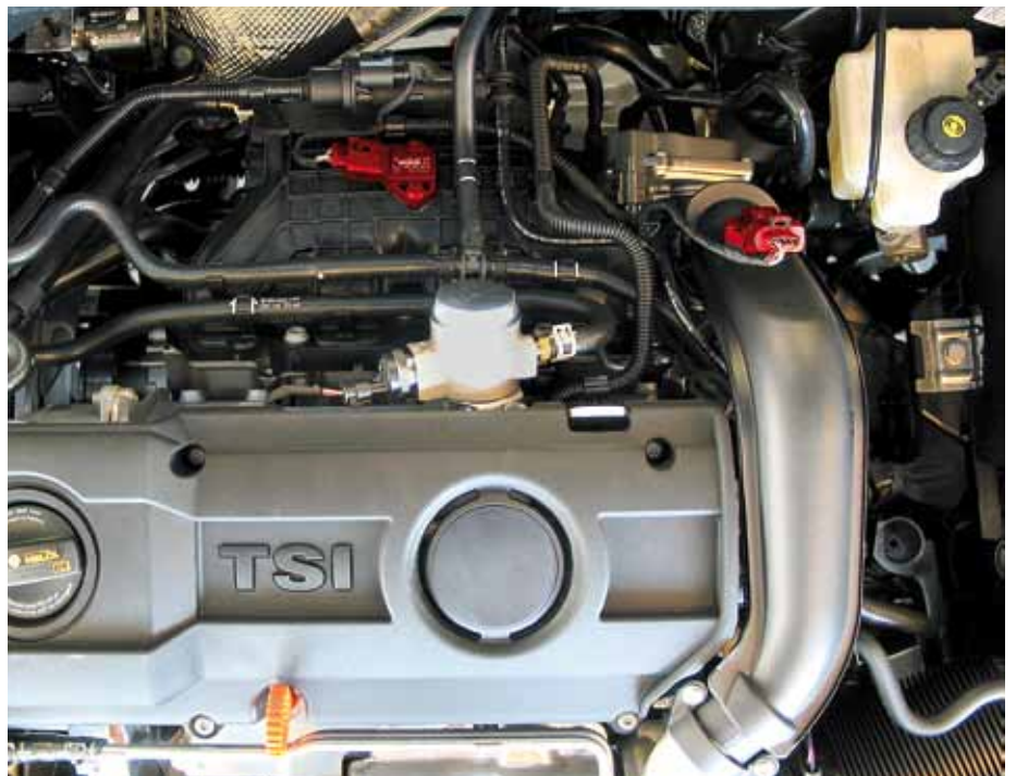
Capteur de pression de la tubulure d'aspiration (à gauche) et capteur de pression d'admission (à droite) sur la VW Golf VI (en rouge)
