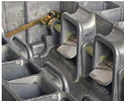
Ein Blick in das Innere eines Schaltsaugrohrs
