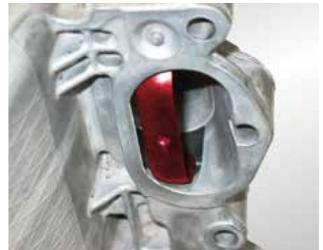
Tumbleklappe (rot hervorgehoben) für den Schichtladebetrieb
