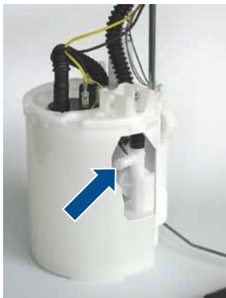
Fig. 1 : Vue dans le module d'alimentation en carburant (coupe verticale) avec bouchon
