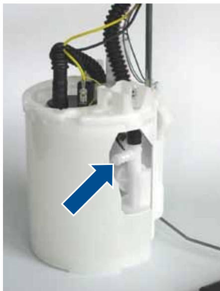
Fig. 1: Vista del módulo de alimentación de combustible (vista vertical) con conector ciego
