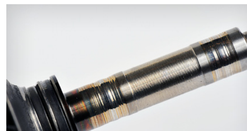
Système de roulement usé et rayé. Transfert de matériaux vers l'arbre
