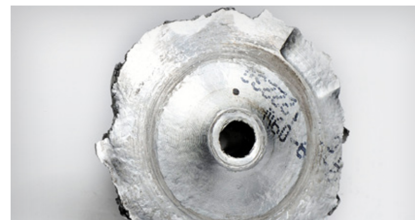
Effet peau d'orange sur la face arrière du compresseur indiquant clairement une vitesse excessive
