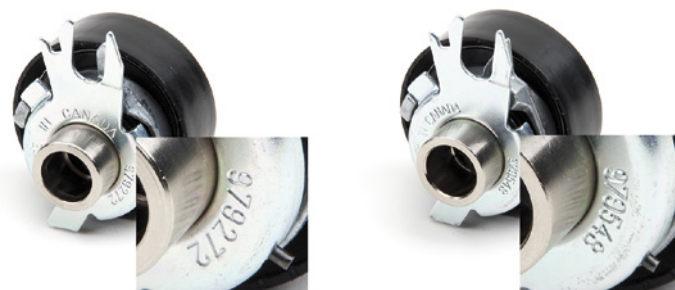
Fig 2: izquierda, polea tensora 531 0252 30; derecha, polea tensora 531 0525 30
