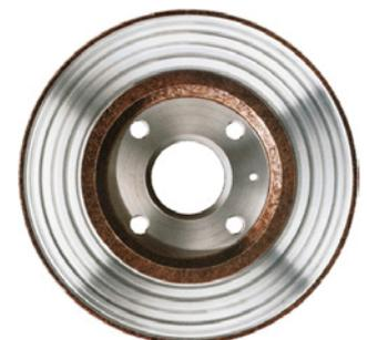
Korrodierte, gerissene oder beschädigte Bremsscheiben immer paarweise auswechseln. .
