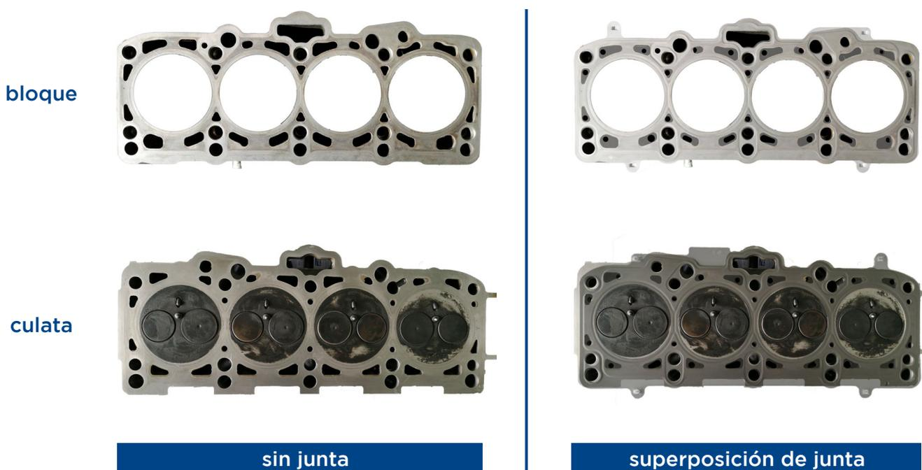
Con ello se busca **controlar el flujo de refrigerante** alrededor de los cilindros y a través de la culata, consiguiendo de esta forma **regular la temperatura del refrigerante** evitando sobrecalentamientos.
