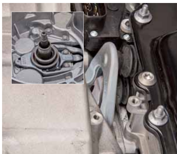
Levier d'engagement en fonte – date de construction de la boîte de vitesses jusqu'à mai 2011, 1 ère génération
