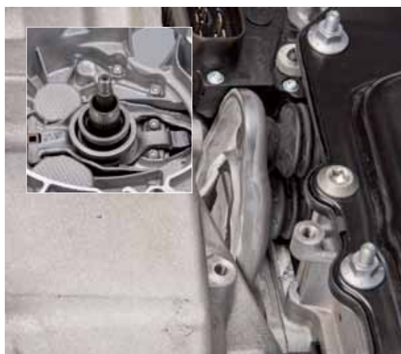
Levier d'engagement en tôle d'acier - date de construction de la boîte de vitesses à partir de juin 2011, 2 ème génération
