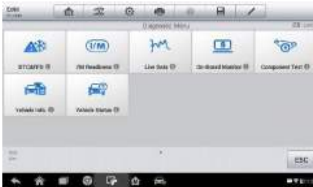
Figure 4-18 Exemple de menu de diagnostic OBD II
