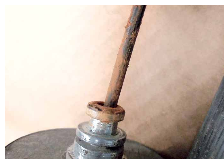
Câble de frein corrodé et tendu
