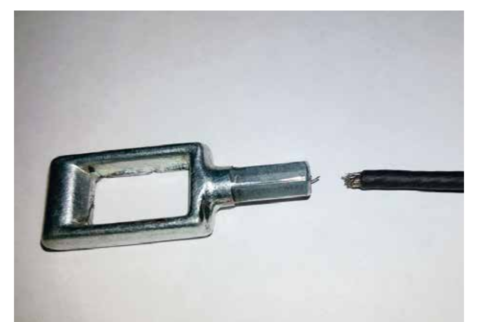
Câble de frein déchiré
