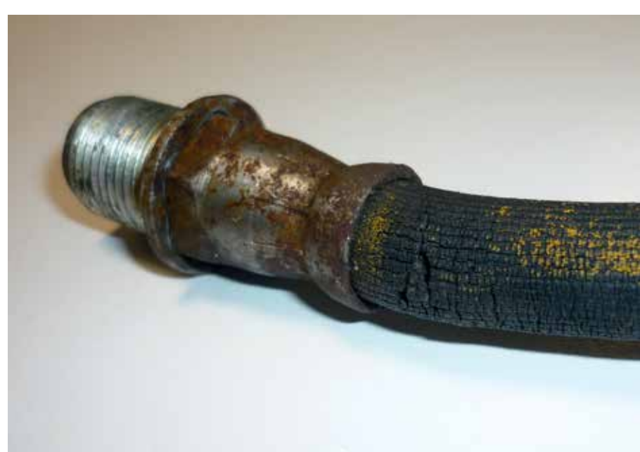
Flexible de frein corrodé
