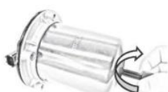
4. Prendre la poignée et la visser dans la cloche.
