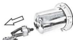
2. Extraire le capteur de la cloche.
