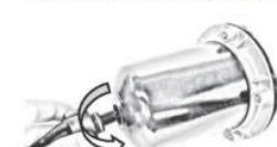
14. Visser le capteur dans la cloche.
