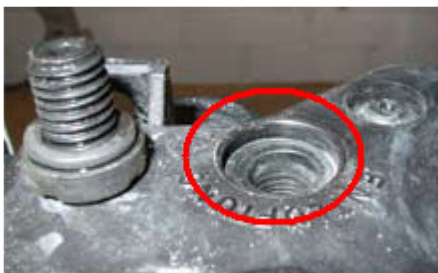
Vis de purge complètement retirée pour faciliter la purge de l'air
