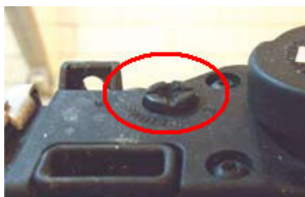
Vis de purge située à côté du bouchon de remplissage
