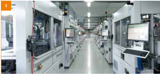
1 Vue d'ensemble de la chaîne de fabrication modulaire des bougies de préchauffage à capteur de pression.
