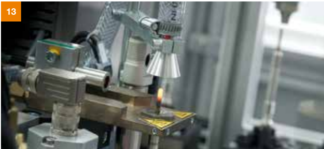
13 Essai de fonctionnement sur 100 % des PSG : l'essai d'incandescence prouve que la bougie atteint la température requise dans le temps alloué.
