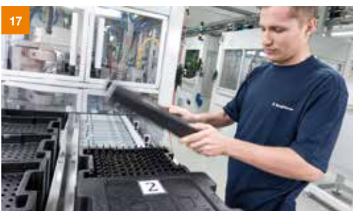
17 Pour terminer, les bougies de préchauffage à capteur de pression sont emballées pour expédition.
