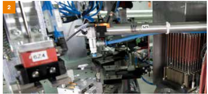
2 Début du processus de fabrication entièrement automatisé : Montage de l'élément chauffant et de son prolongement...
