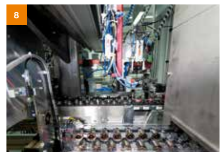
8 Le connecteur de courant de préchauffage est introduit par le conduit à l'intérieur du module du capteur.
